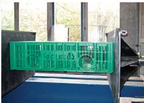
Испытание на устойчивость к нагрузкам
